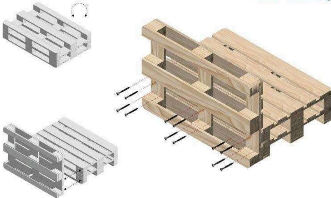
Gegebenenfalls können an dieser Stelle auch Armlehnen montiert werden. Hierfür schneiden Sie mit einer Stichsäge eine weitere Palette an den mittleren Holzklötzen der Länge nach auseinander. Die Armlehnen werden bündig an der vorderen Sitzfläche positioniert und erneut mit Schrauben angebracht.
